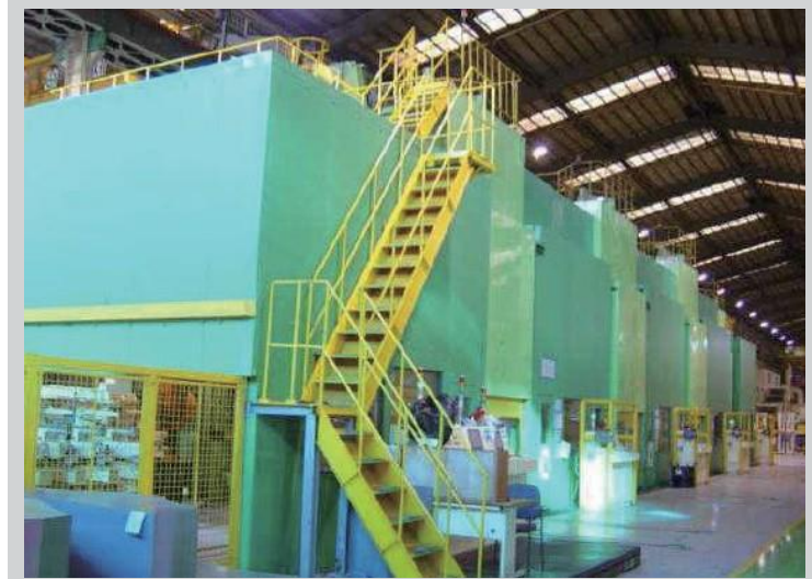
대형설비 상부 점검통로 안전난간 설치
